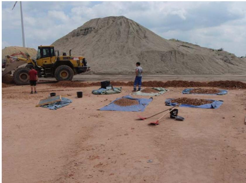
Abbildung 5-52: Probenahme Baurestmassen Zwischenlager (TU Wien)
