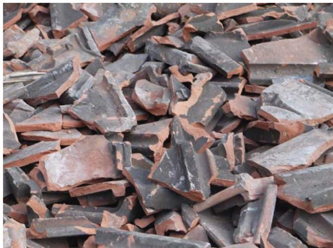
Abbildung 5-21: Ziegelbruch (Dachdeckung)
