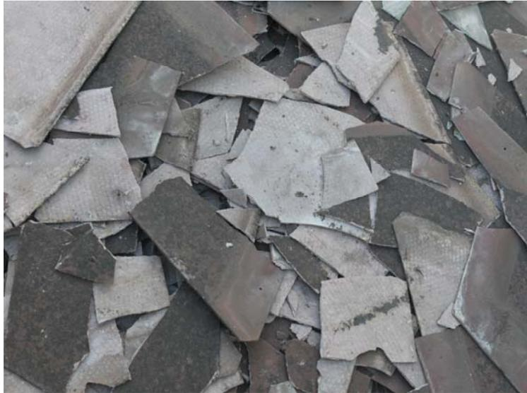
*Abbildung 5-26: getrennt gesammelte Faserzementplatten*
