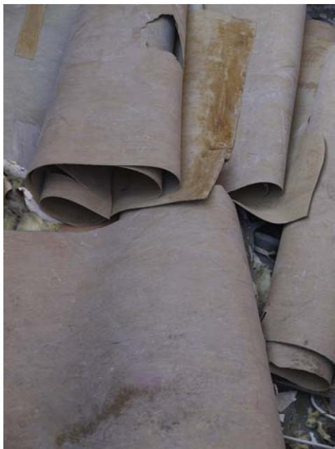
Abbildung 5-17: Rückgebaute und getrennt gesammelte Bahnen von Kunststoffbodenbelägen
